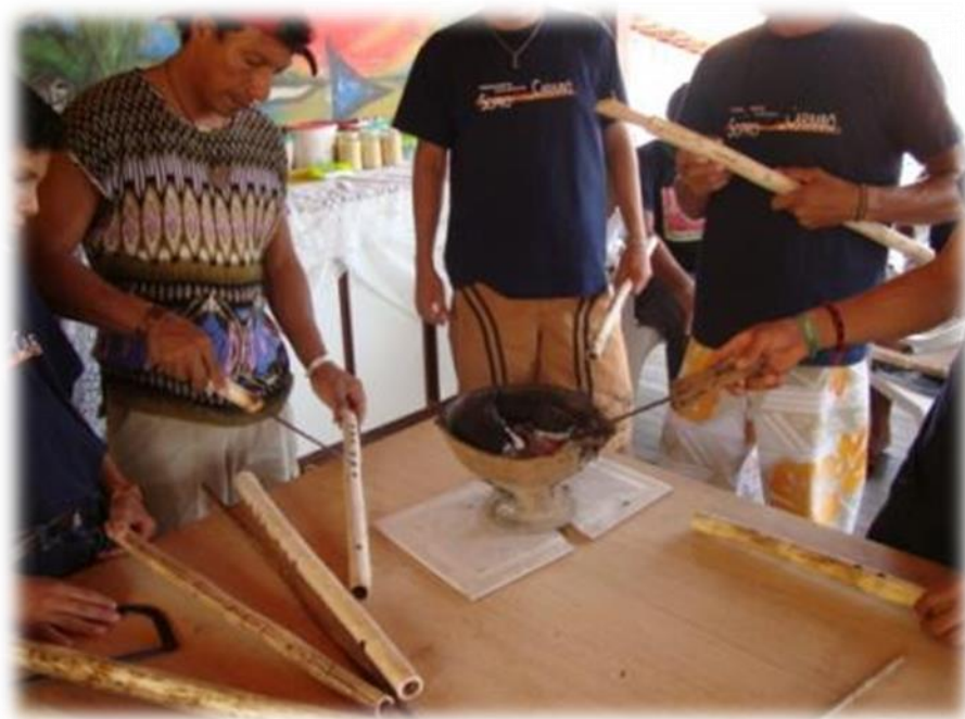
Figura 43 Fabricação da flauta de imbaúba Foto: Walter Figueiredo
